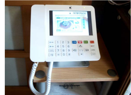
IP告知システム ピーちゃんねつと端末(出典:岩泉町ホームページ) 地域IPネットワーク網を活用して、役場と住民の双方間で、J-ALERT・地震・台風・豪雨・津波などの災害時緊急放送や行政放送を行うもの
