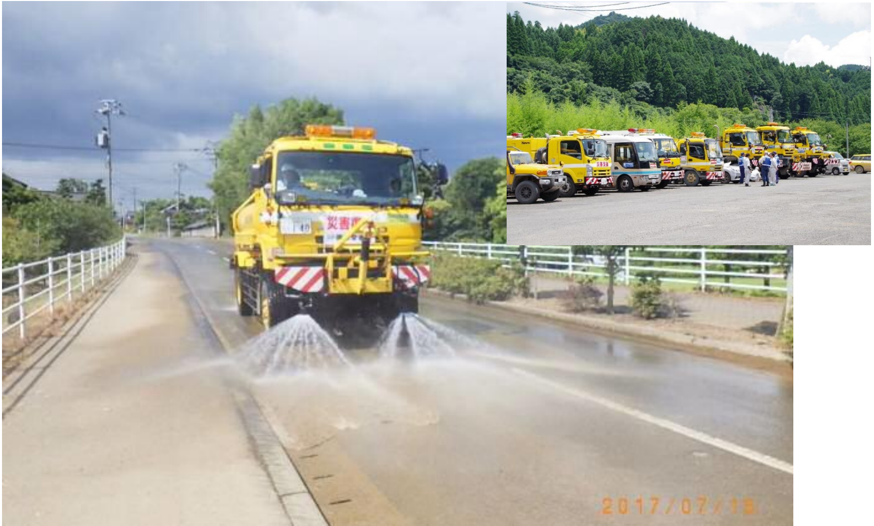
【散水車で砂塵飛散対策を実施(朝倉市、東峰村)】
