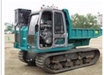
簡易遠隔操縦装置
