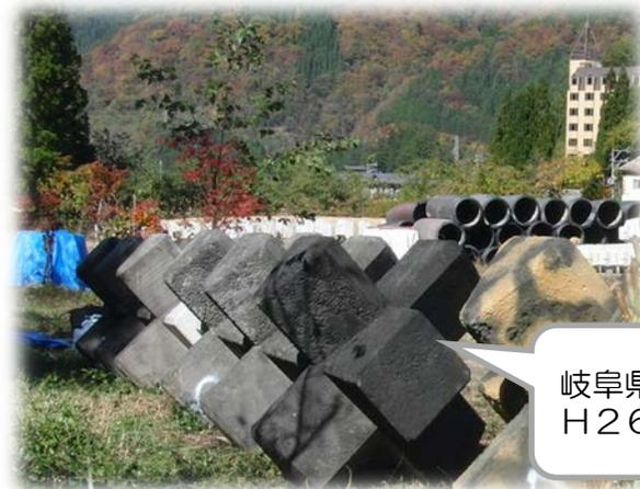
粗面仕上げ+吹きつけによる明度低下例
