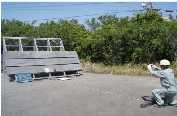
護岸ブロックの明度計測方法の確立・普及と証明
