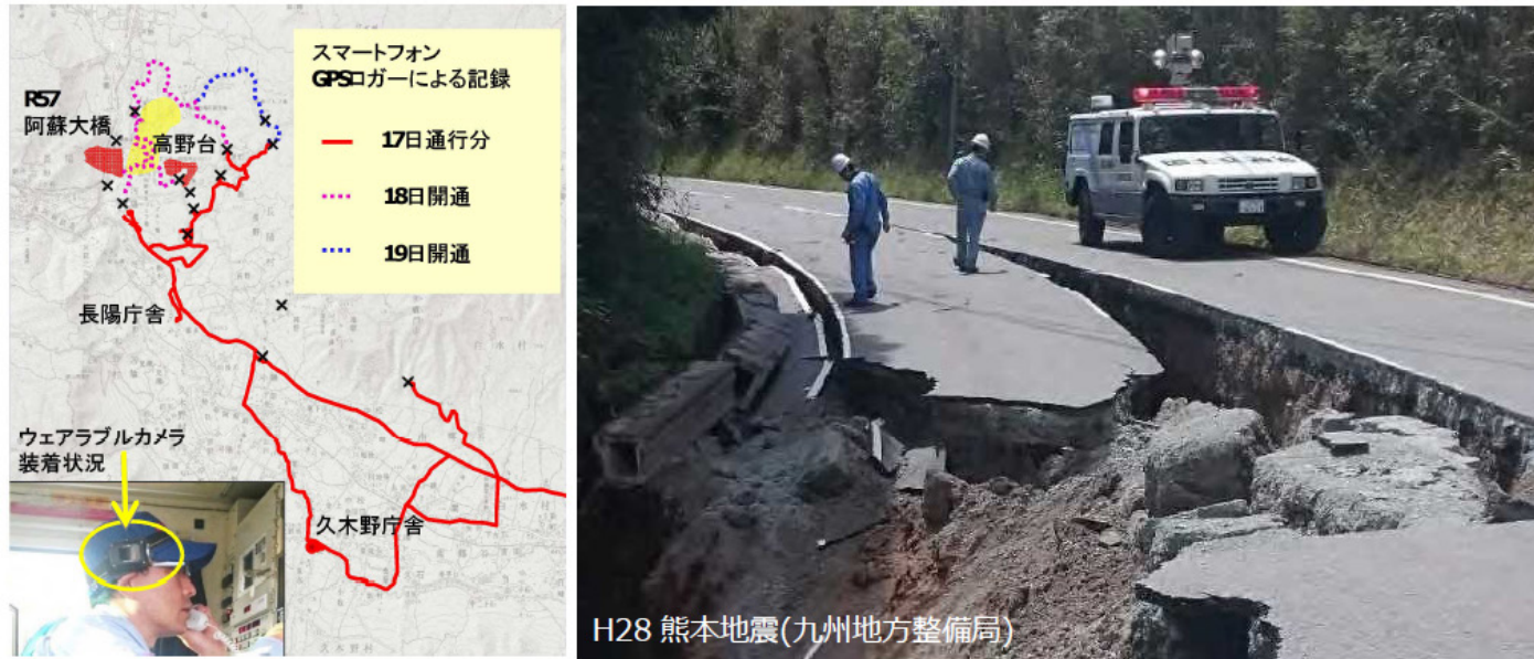
図 携帯 GPS による走行ルート記録とウェアラブルカメラで撮影した被災箇所写真の事例
