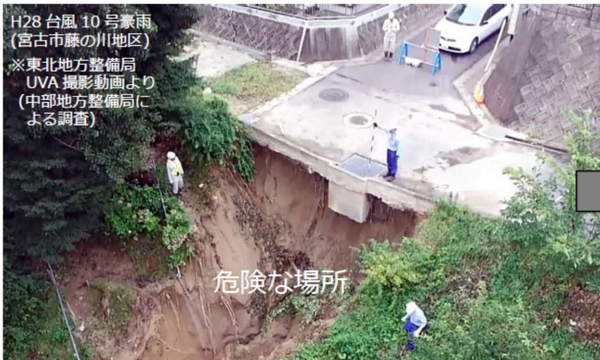
図 災害現場に立ち入ることができない危険な場所でのレーザー距離計の活用
