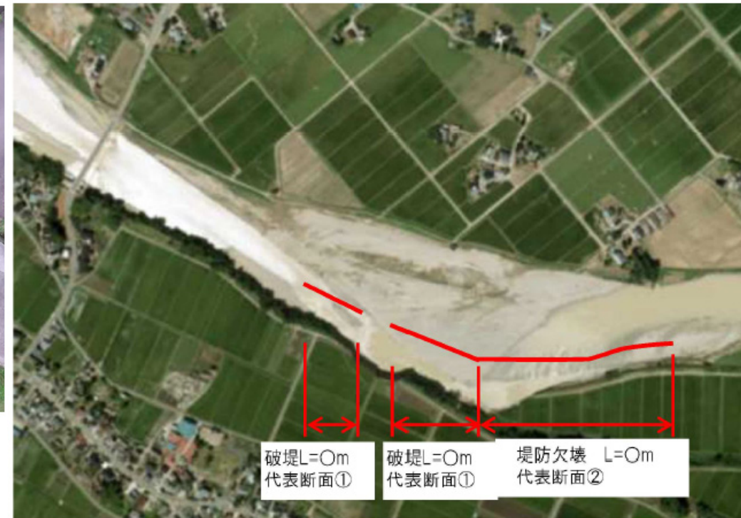
図 TEC-FORCE 被災状況調査【様式-15 調査表】や航空写真で平面図を作成した事例
