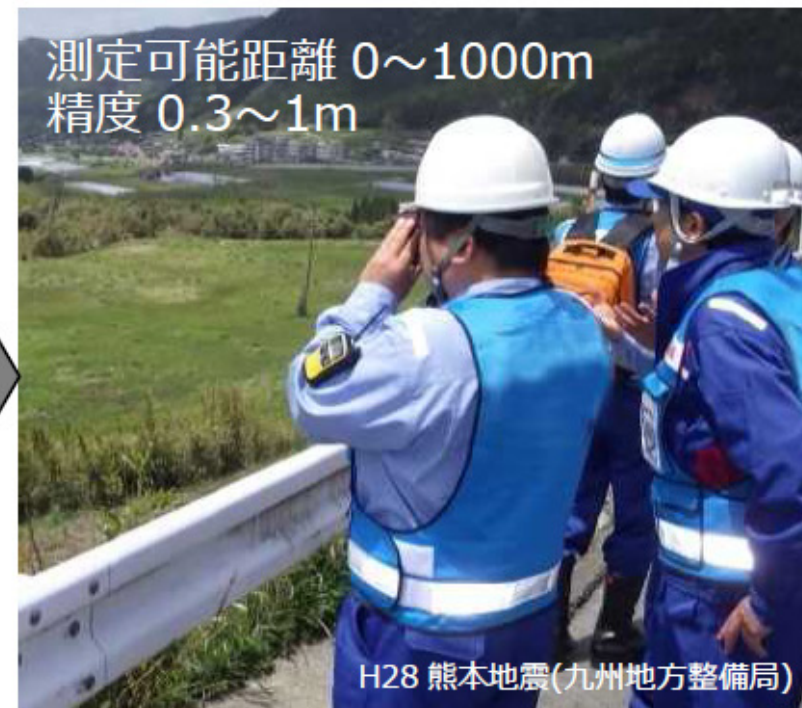
図 災害現場に立ち入ることができない危険な場所でのレーザー距離計の活用
