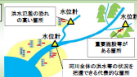
水位計の設置箇所のイメージ
