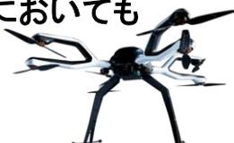
風速20m/s程度の強風下で飛行可能
