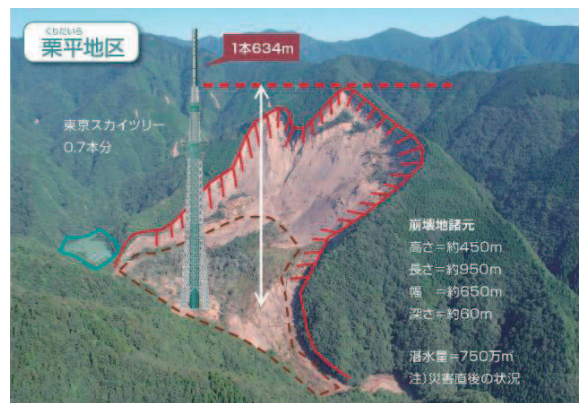
栗平地区の被災状況 (東京ドーム11.6杯分の崩壊土砂量 (約1,390万m 3 ))
