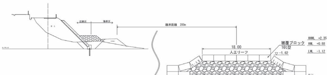
復旧計画断面図（人工リーフ：復旧実施断面は被覆ブロック 25t型 N=10個）
