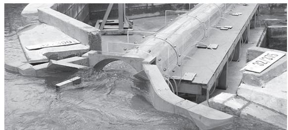
写真-2 呑口部の構造(水理模型実験)
