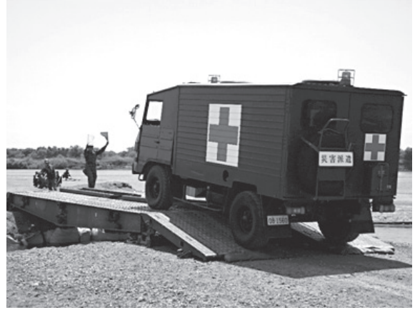
陸上自衛隊の自走架柱橋仮設による孤立地域住民救出訓練
