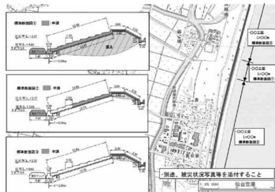
※代表的な被災形態を定め、申請(復旧)計画の標準断面図で設計書を作成。
