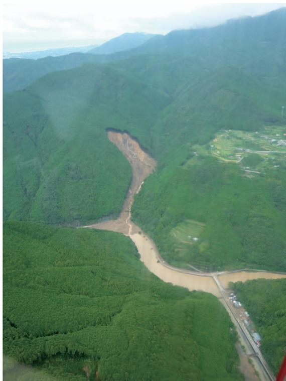
写真－5 土砂災害と河道の埋塞状況
