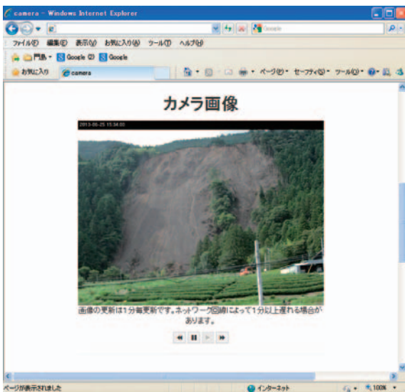
図-3 webカメラによる遠隔監視
