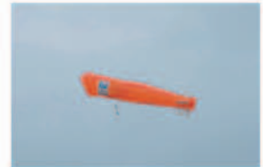
気球空撮システムによる港湾の被災状況調査
