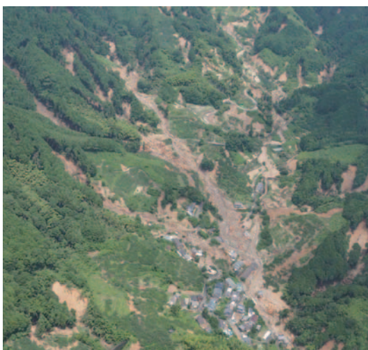
写真－1 山腹崩壊が多数発生した福岡県朝倉市
