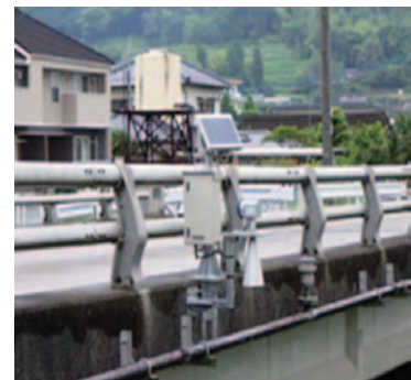
設置された危機管理型 水位計（大分県提供）
