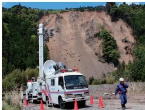
写真－9 照明車により夜間の斜面監視及び映像情報による遠隔監視が可能となった
