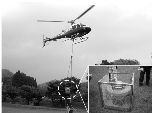
写真-10 ヘリコプターで投入された湯浜地区の水位観測機器
