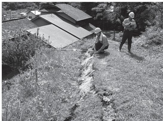
写真一 4 緊急点検で危険度Aと判定された箇所(宮城県旧鳴子町)
