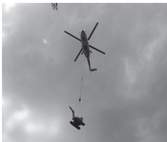
写真-11 ヘリコプターにより搬入される分解された重機等
