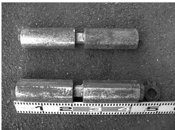
地震により飛び散った支承部のローラー
