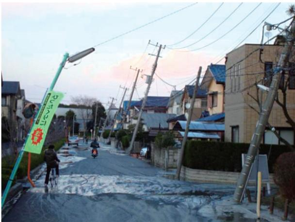
液状化により傾いた電柱
