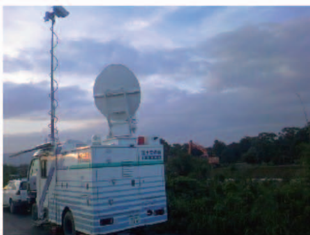
オキノハタ 衛星通信車による沖 端 川復旧状況の中継 (福岡県へも映像提供)
