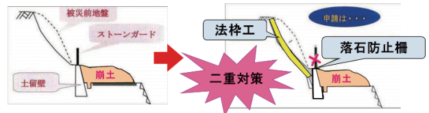
図-3 法面対策として、法枠工+落石防止柵を申請(二重対策と判断される事例)
