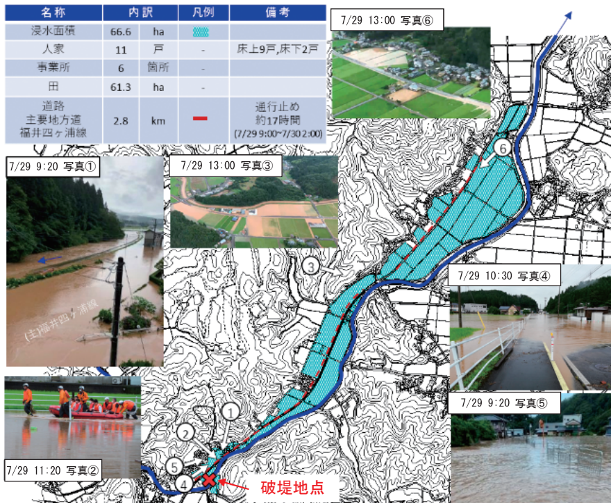
図-4 志津川浸水範囲、被災写真
