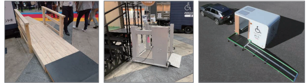
図 段差の解消方法(低床式車両の導入/スロープ・リスト設置)
